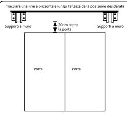
Installare i supporti a muro sotto ciascun braccio di estensione per un supporto migliore. Per vedere gli attachi delle tende d'estensione, manualmente estendere la tenda con la maniglia a manovella quanto basta per vedere gli attachi all'interno del cassonetto totale.
