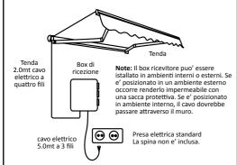
E' consigliabile posizionare il box ricevitore in un abiente interno o dentro una copertura impermeabile.
